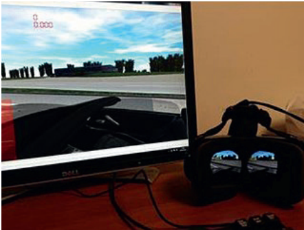
◀ Casque de réalité virtuelle permettant d'afficher les images en 3D et de mesurer les mouvements de la tête
