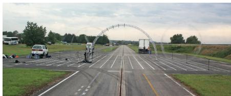
◀ Projet GEODE – Mesure de l'émission acoustique d'un véhicule dans le plan vertical
