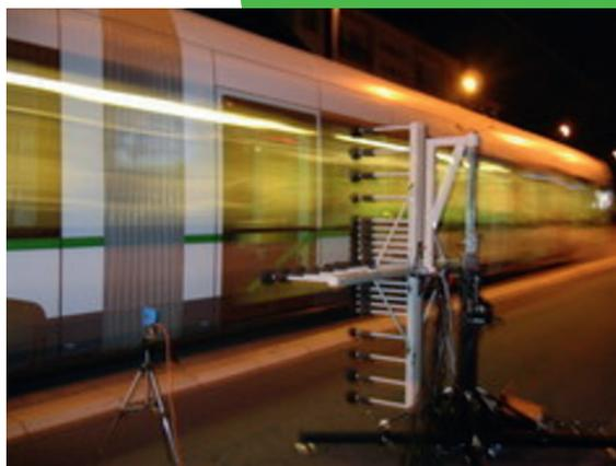
▲ Localisation et caractérisation des sources de bruits au passage d'un tramway par antenne microphonique.
