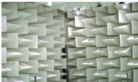
▲ Salle semi-anéchoïque « Marin Mersenne » (SSA) : enceinte isolée dont les murs et le plafond sont capitonnés pour absorber l'énergie acoustique incidente.
