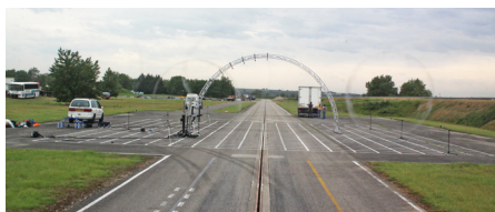
◀ Projet GEODE – Mesure de l'émission acoustique d'un véhicule dans le plan vertical
