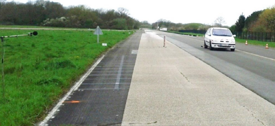
▲ Mesure en continu du bruit de roulement.
